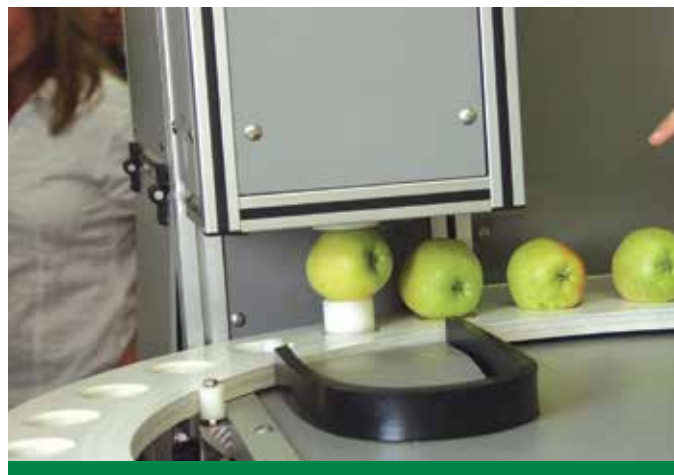
Az alma minőségét korszerű berendezéssel, roncsolásmentesen tudják vizsgálni
